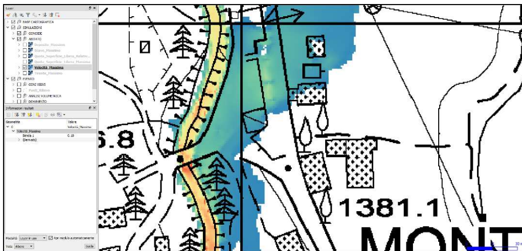
Simulazione velocità massima – Area di realizzazione della cabina di consegna Studio Università di Trento - DICAM
