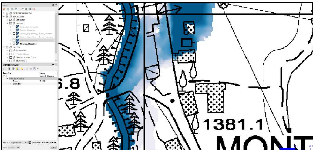
Simulazione tirante massimo – Area di realizzazione della cabina di consegna Studio Università di Trento - DICAM
